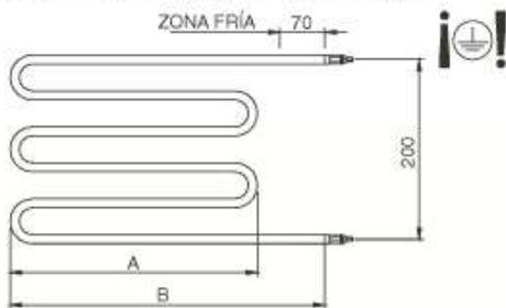
Resistencias en forma de "M" con 8 columnas. Gama M8ST
