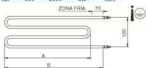
Resistencias en forma de "M" con 6 columnas. Gama M6ST
