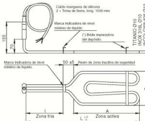
(\*) NOTA: La brida separadora del depósito se suministra únicamente con los modelos de la gama SIYU, SIYM y SIYMN
