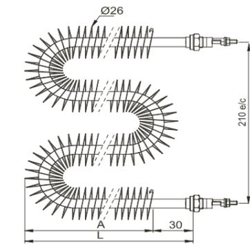
**CALEFACTORES ALETADOS HELICOIDALES EN FORMA "M4", MODELOS AHM**
