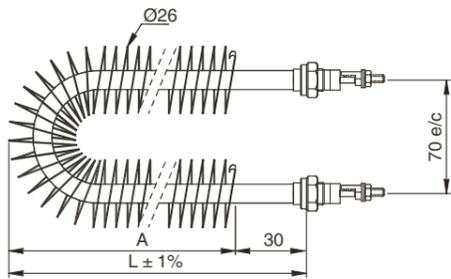
**CALEFACTORES ALETADOS HELICOIDALES EN FORMA "U", MODELOS AHU**
