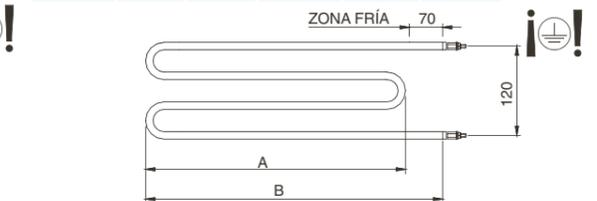
**Resistencias en forma de "M" con 6 columnas. Gama M6ST**
