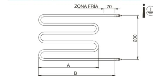
**Resistencias en forma de "M" con 8 columnas. Gama M8ST**
