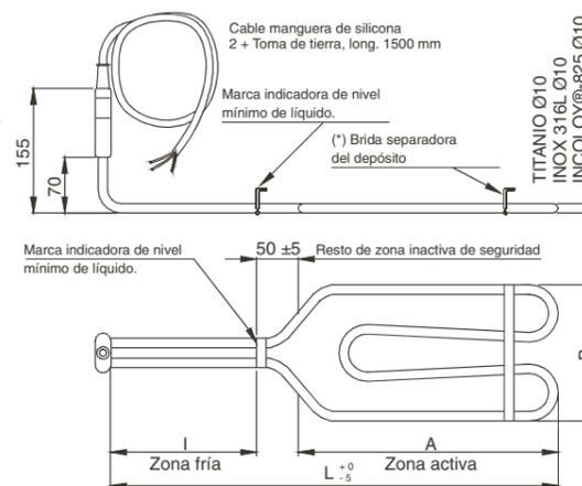
(\*) NOTA: La brida separadora del depósito se suministra únicamente con los modelos de la gama SIYU, SIYM y SIYMN
